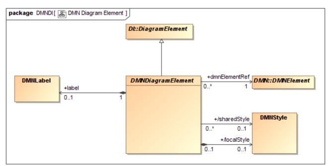
Figure 13.3: DMNDiagramElement
